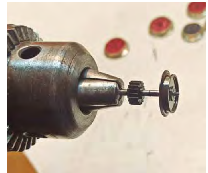
Fotografía 4. Rueda con su eje puesta en el cabezal de un taladro situado en horizontal.
