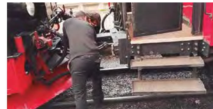
La tripulación del tren engancha la locomotora y conecta las mangueras de calefacción y freno
