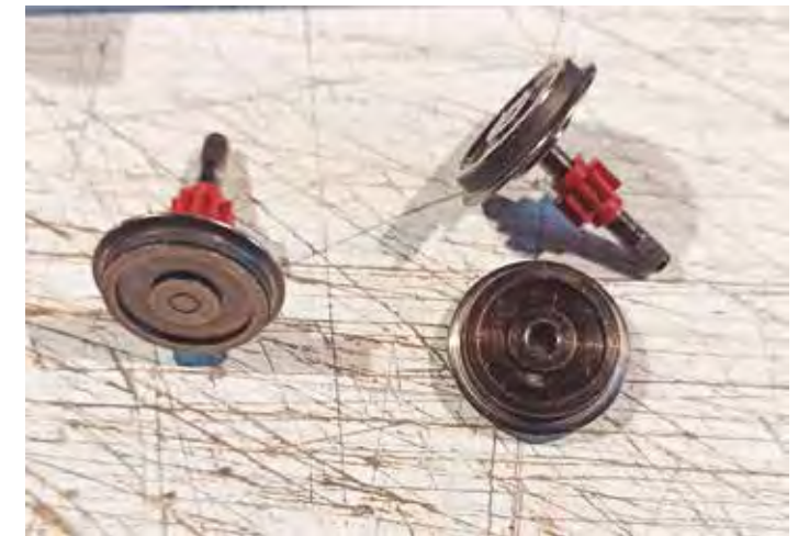
Fotografía 3. El eje con una rueda extraída preparada para empezar el trabajo.
