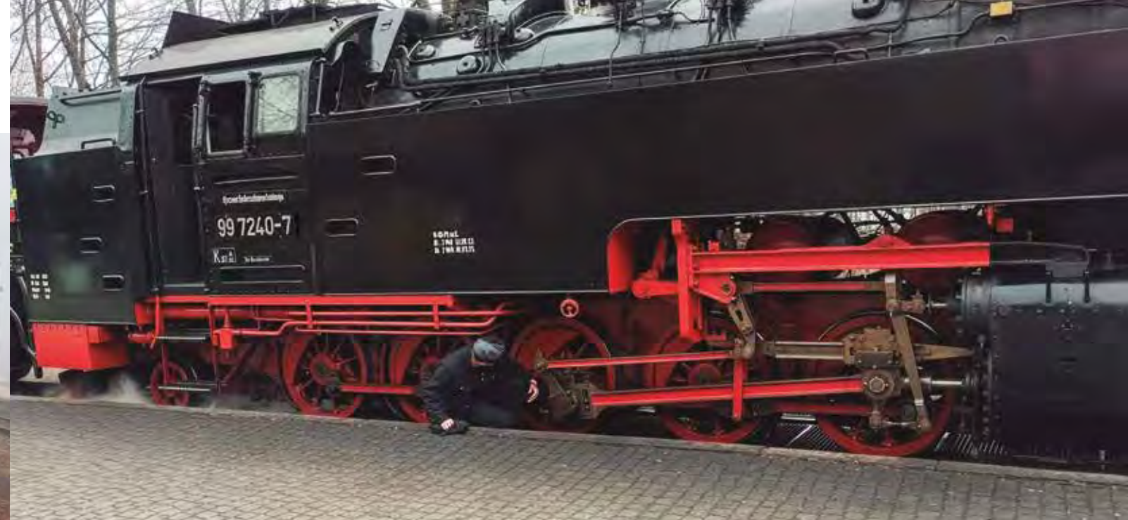
Se aprovecha la parada para revisar bielas, engrasadores, frenos y otros elementos de las locomotoras
