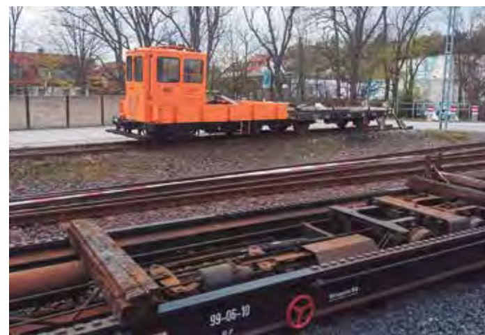
Dresina de servicio del HSB. En primer término, plataforma para transportar vagones de ancho normal por la vía de ancho métrico.
